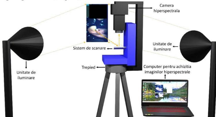
Fig. 7. Aranjament experimental pentru achiziția imaginilor hiperspectrale pentru aplicatii clinice.
